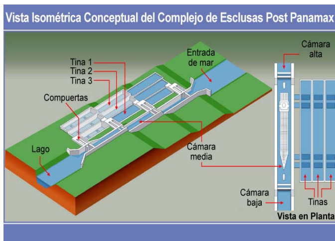
Gráfica 1 Vista isométrica del complejo de esclusas post panamax con sus compuertas y tres tinas de ahorro de agua por cámara. A la derecha vista en planta de una cámara con sus tinas de ahorro de agua.
